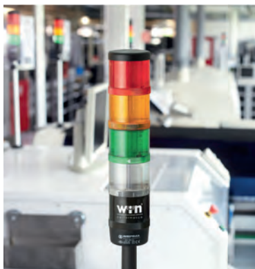
Jederzeit erweiterbar: mit zusätzlichen „WIN transmitter“ können bis zu 50 Maschinen in das Netzwerk integriert werden
