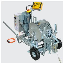
Die Winde ist in zwei verschiedenen Ausführungen lieferbar. Mit einem Dynamometer mit einstellbarer Höchstlast und automatischer Abschaltung oder mit einem elektronischen Registriergerät, das die Zugkraft, die Länge, sowie die Geschwindigkeit per m/min. digital anzeigt und speichert. Über einen USB Anschluss können alle Daten auf den PC oder Laptop übertragen werden. Die Winde ist aus Sicherheitsgründen auf der untersten Seillage auf 5,0 kN beschränkt.
