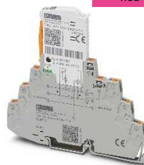
Doppelader (Loop), erdpotenzialfrei, Anschluss 3/6 direkt geerdet, mit Messertrennung, z. B. für 4 ... 20 mA Stromschleife
