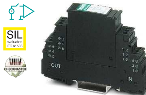
4-Leiter mit gemeinsamem Bezugspotenzial, Anschluss 9/10 über Gasableiter geerdet, z. B. für Binärsignale
