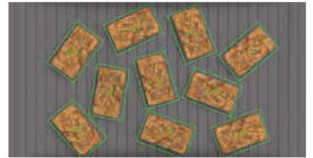
Produkterkennung: 10 Teile mit Rotation < 200 ms
