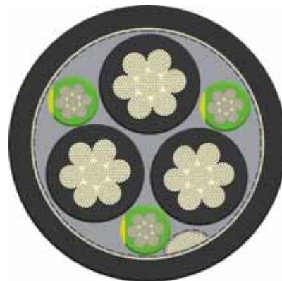
Symmetrischer Aufbau mit gedritteltem Schutzleiter
