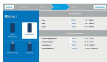
3. Schritt: Angaben zu Verlustleistung und Umgebungsparameter
