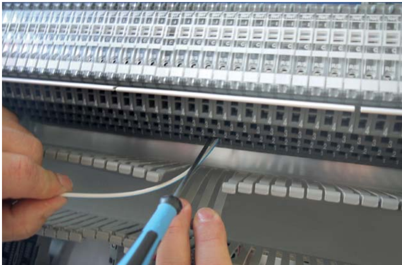
Im Vergleich: Montageplatte - Behinderung durch Kanal
