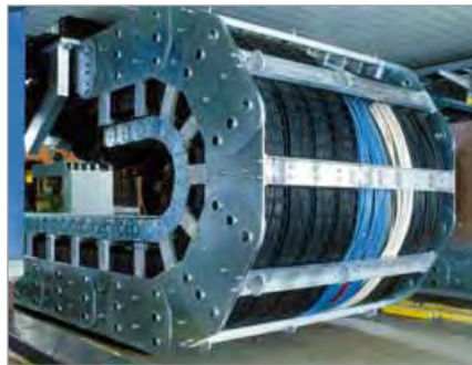
Energieführungsketten Typenreihe MK 0475 zur Separierung der Leitungen in einer Energieführungskette aus Stahl Typenreihe 3200 an ZEUS-Detektor Foto: Deutsches Elektronen-Synchrotron, Hamburg
