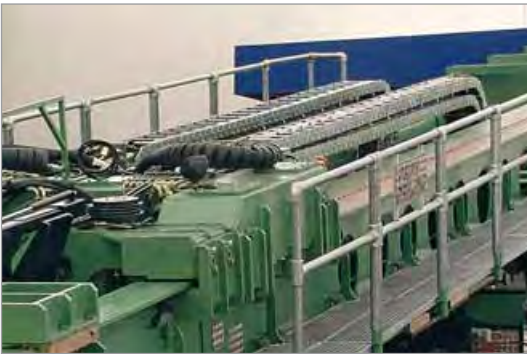
Energieführungsketten aus Stahl an einer Bohranlage
