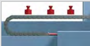
■ Energieführung mit Zusatzlast (Leitungen und Schläuche)
