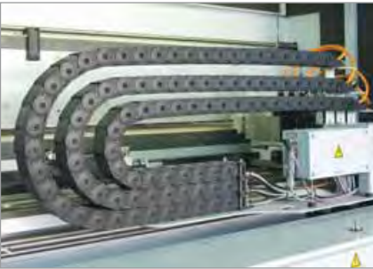
Energieführungs-System QUANTUM an einer Holzbearbeitungsmaschine
