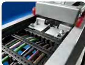
Automatische Notabschaltung mit Entkopplung der Energieführung
