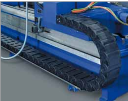
Energieführungsketten Typenreihe MT 0950 an einer Walzen-Schleifmaschine – Einbauvariante: horizontal – „freitragend“ Foto: Waldrich Siegen Werkzeugmaschinen GmbH
