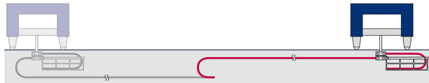
■ Emergency Cable Carrier am Rail Cable Carrier. Das System kann aber ebenso auf gleitende Anordnungen adaptiert werden.
