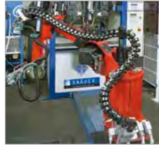
Energieführungssystem ROBOTRAX : Drehwinkel von ca. 180° ohne Kanalsystem an einer Knickarmroboter- Anwendung Fotos: Reis Robotics, Arthur Bräuer GmbH & Co. KG
