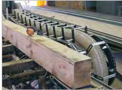
Energieführungs-System QUANTUM an einer Holzbearbeitungsmaschine
