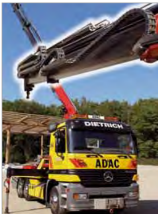
Energieführungsketten der MONO- und UNIFLEX- Serie an einem Abschleppwagen
