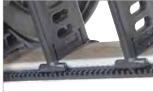
■ Trennstegfixierung durch Fixierungsprofile
