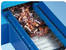
Scharnierbandförderer – bewährt für viele Entsorgungsaufgaben
