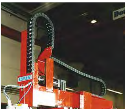
Energieführungsketten der MONO-Serie Typenreihe 0450 Einbauvarianten: horizontal „freitragend“ – und vertikal „stehend“ Foto: Reis Robotics
