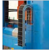
Energieführungsketten aus Stahl und Kunststoff sowie KABELSCHLEPP Teleskop-Abdeckungen an einer Portalfräsmaschine Foto: Waldrich Siegen Werkzeugmaschinen GmbH
