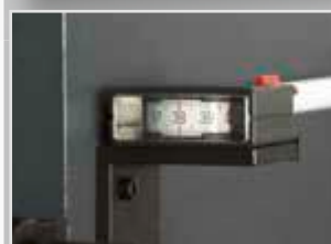
Maßbandanzeige für Y-Achse
