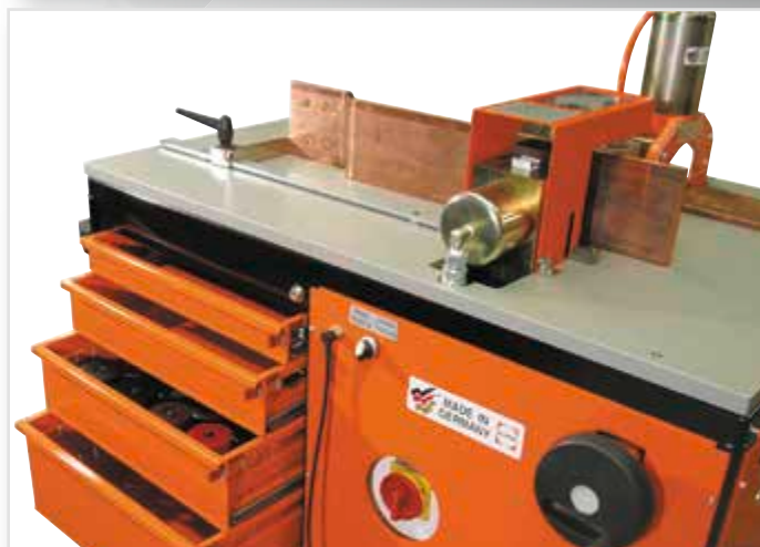
Im Wagen befinden sich 4 Werkzeugschubladen mit Facheinteilung für Lochstempel und Matrizen.
