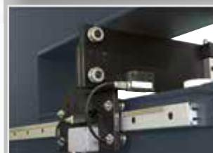
Wegmessung der X- und Y-Verfahrwege
