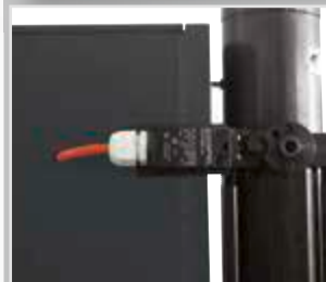
Elektrische Sicherheitsverriegelung zur Unfallverhütung.
