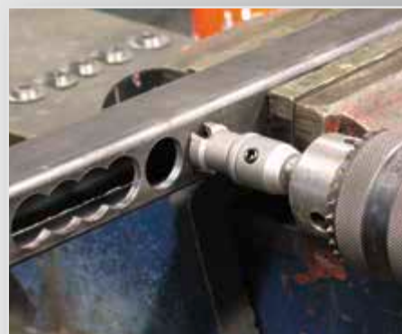
Bohren in Quadratprofil
