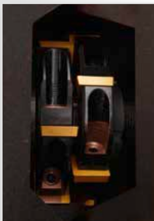
2 Frässcheiben gekoppelt mit je 6 Wendeplatten
