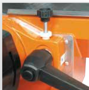
Feinjustierung der Frästiefe/Fasenbreite
