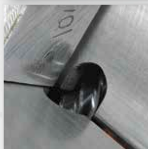
Exaktes Entgraten durch Abwälzfräsen
