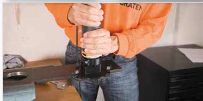
Startbohrungen ab: Ø 3,0 mm bei Stiftfräsern Ø 5,0 mm bei Kegelfräsern
