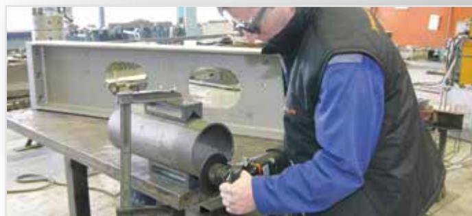
Startbohrungen ab Ø 20 mm
