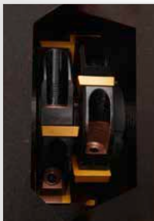
2 Frässcheiben gekoppelt mit je 6 Wendeplatten
