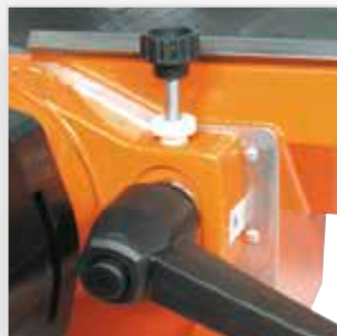
Feinjustierung der Frästiefe/Fasenbreite
