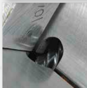
Exaktes Entgraten durch Abwälzfräsen
