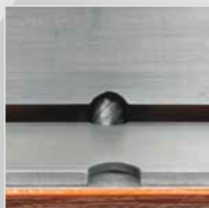
Stellung I: Materialstärken ab 4,5 mm
